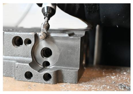
H1031\_Einsatz: Mit den Kombinationsformen können verschiedene Bearbeitungen mit einem Werkzeug erledigt und somit die Produktionszeit verkürzt werden.
